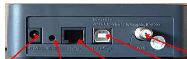
konektor DC napajanja taster za reset LAN port USB port RF "F" konektor
